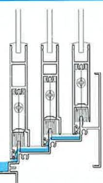
独自の下枠形状が雨水の侵入を抑えます。
